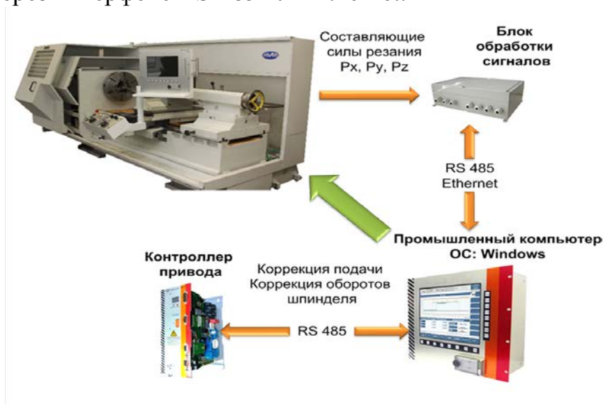
Рис. 4. Реализация встроенной системы диагностирования режущего инструмента в ЧПУ
