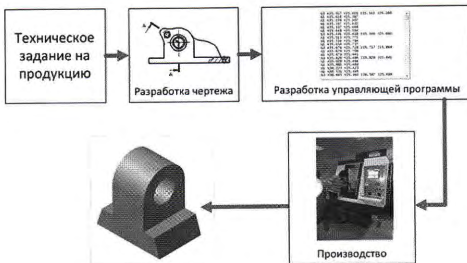
Рис. 6. Жизненный цикл продукции фрезерной обработки
