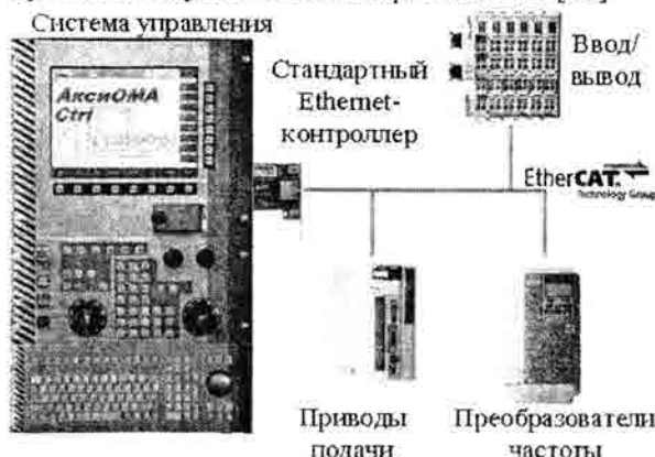
Рис. 7. Решение на базе протокола EtherCAT
