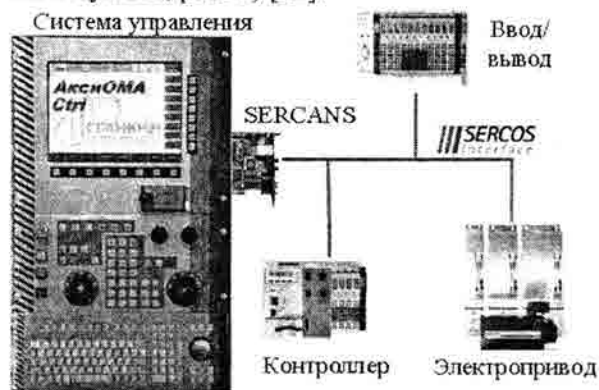
Рис. 8. Решение на базе протокола SERCOS
