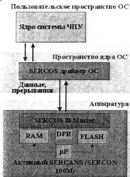
Рис. 6. Архитектура модуля управления SERCOS устройствами
