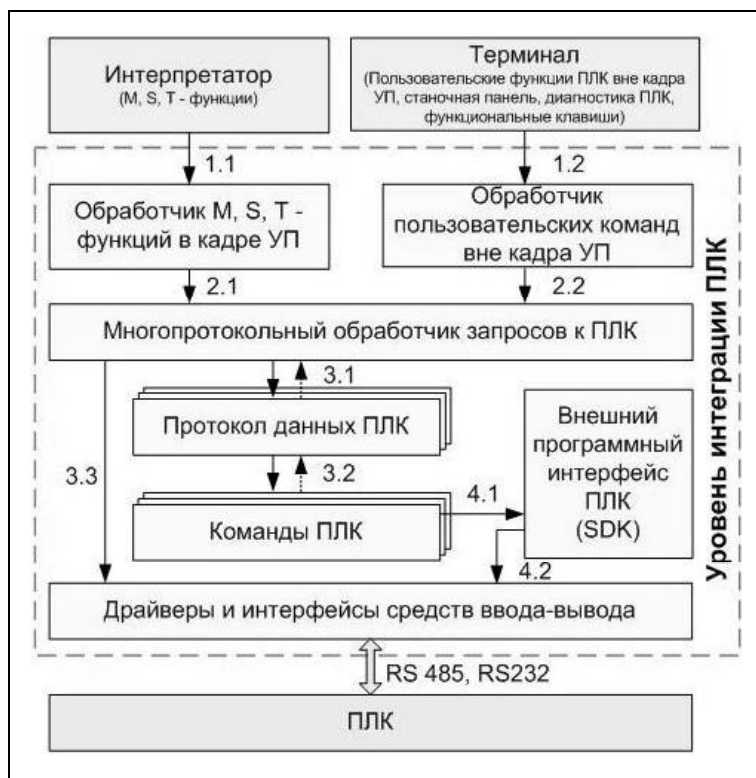
Рис. 3. Обобщенная архитектура компонентов коммуникационной части логической задачи
