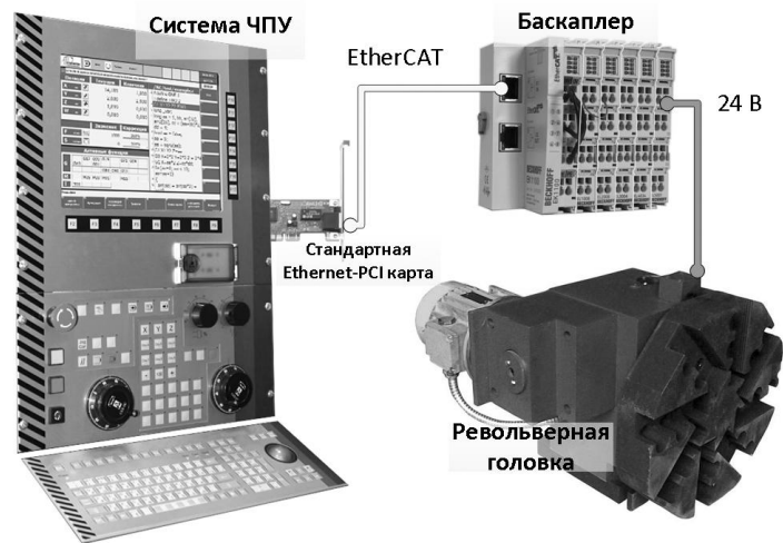
Рисунок 3. Пример практического применения EtherCAT в задачах управления электроавтоматикой
