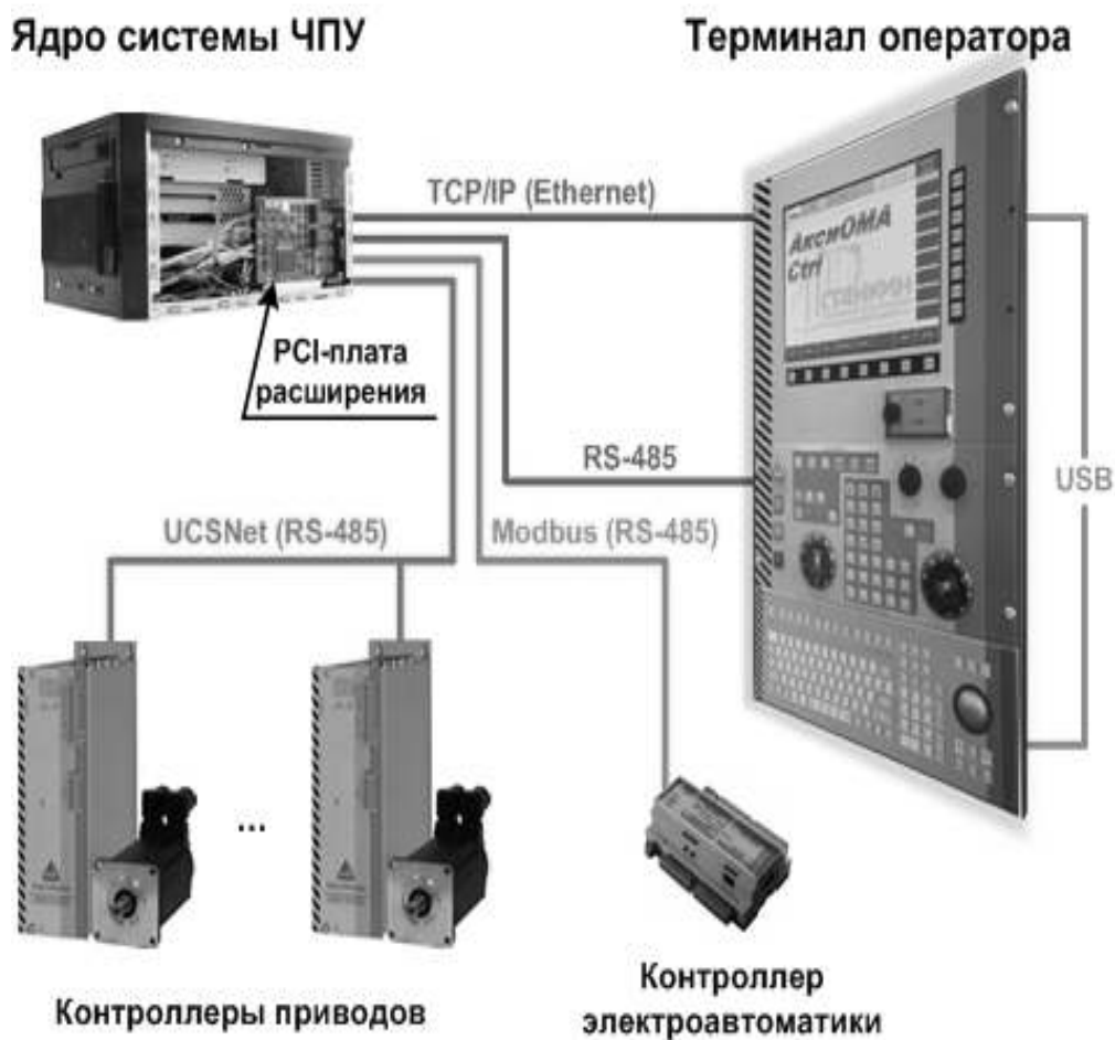
Рис. 1. Архитектура системы числового управления
