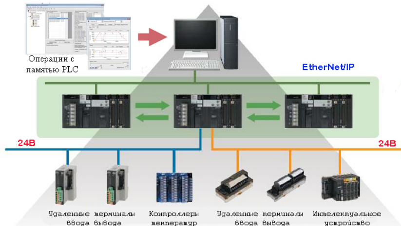
Рис. 2 Архитектура системы управления при использовании протокола EtherNet/IP
