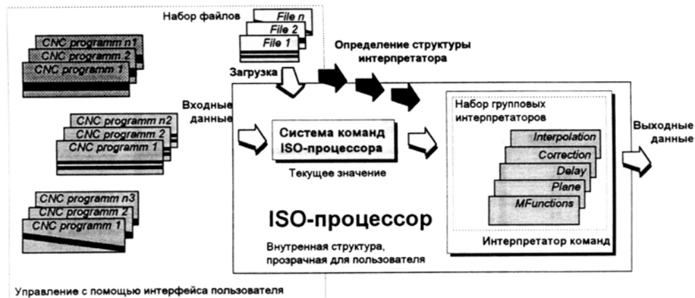
Рис. 5. Обеспечение гибкости ISO-процессора путем выбора системы команд из базового набора
