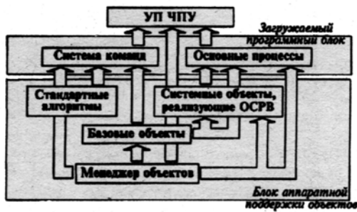
Рис. 10. Схема программно-аппаратной реализации ISO-процессора
