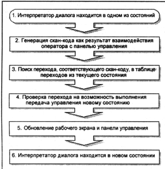
Рис. 7. Блок-схема перехода из одного состояния в другое таблица инициализируется и заполняется только для сложных состояний.
