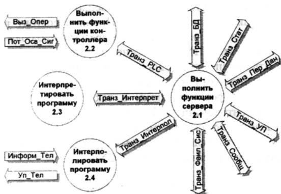
Рис. 6. Декомпозиция процесса "Управлять объектом": Транз_Интерпол — транзакции интерполятора; Транз_Интерпрет — транзакции интерпретатора; Транз_PLC — транзакции PLC; остальные обозначения см. на рис. 3—5
