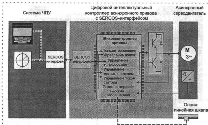
Рис. 5. Цифровой следящий привод с SERCOS-интерфейсом
