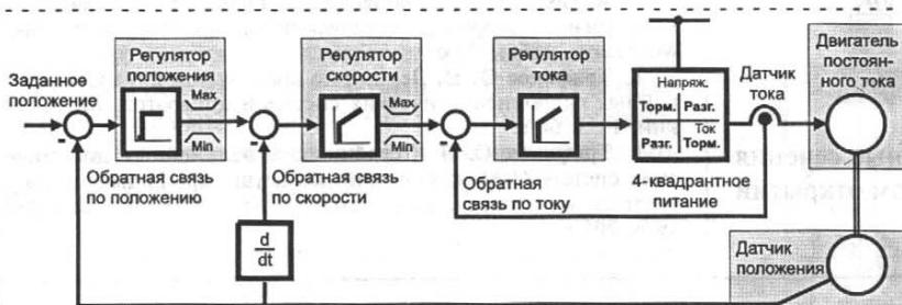
Рис. 1. Каскадная структура традиционной следящей системы с двигателем
