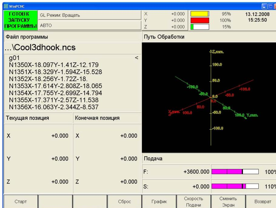
Выбрать кнопку «Старт», после нажатия этой кнопки, перед началом отработки рабочей программы, станк начнет операцию вывода приводов в «0»:
